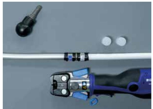
Der Übergang auf Multilayer-Fremdsysteme funktioniert ohne Fremdwerkzeuge und ohne Gewindeübergänge.
