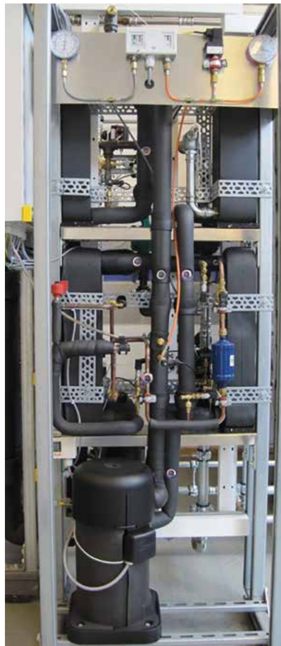
Abb. 7: Pilotanlage an der Hochschule München: Wärmepumpen-Aufbau im Labor, der letztendlich zur Patentanmeldung geführt hat.
